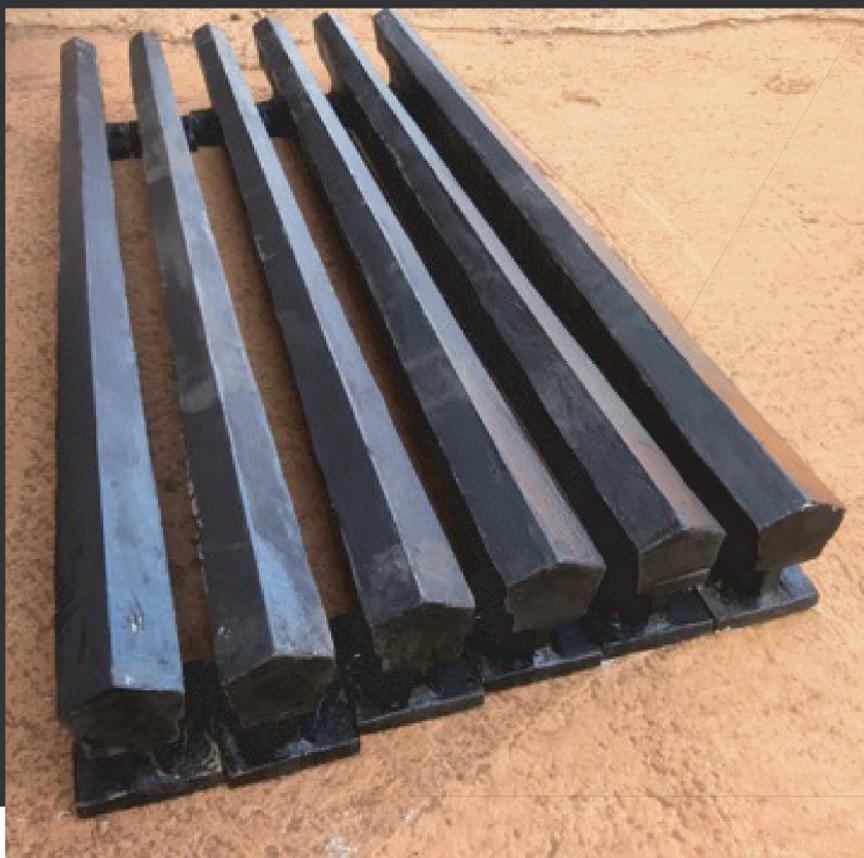
**Trilho Grizzly Bar, fundidas em Aço Baixa Liga, conforme Norma ASTM A148 modificado, desenvolvido com Dureza de 450 HB, tratadas termicamente com têmpera e revenimento.**
